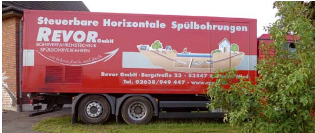
Versorgungsfahrzeug mit Bentonitmischanlage.
